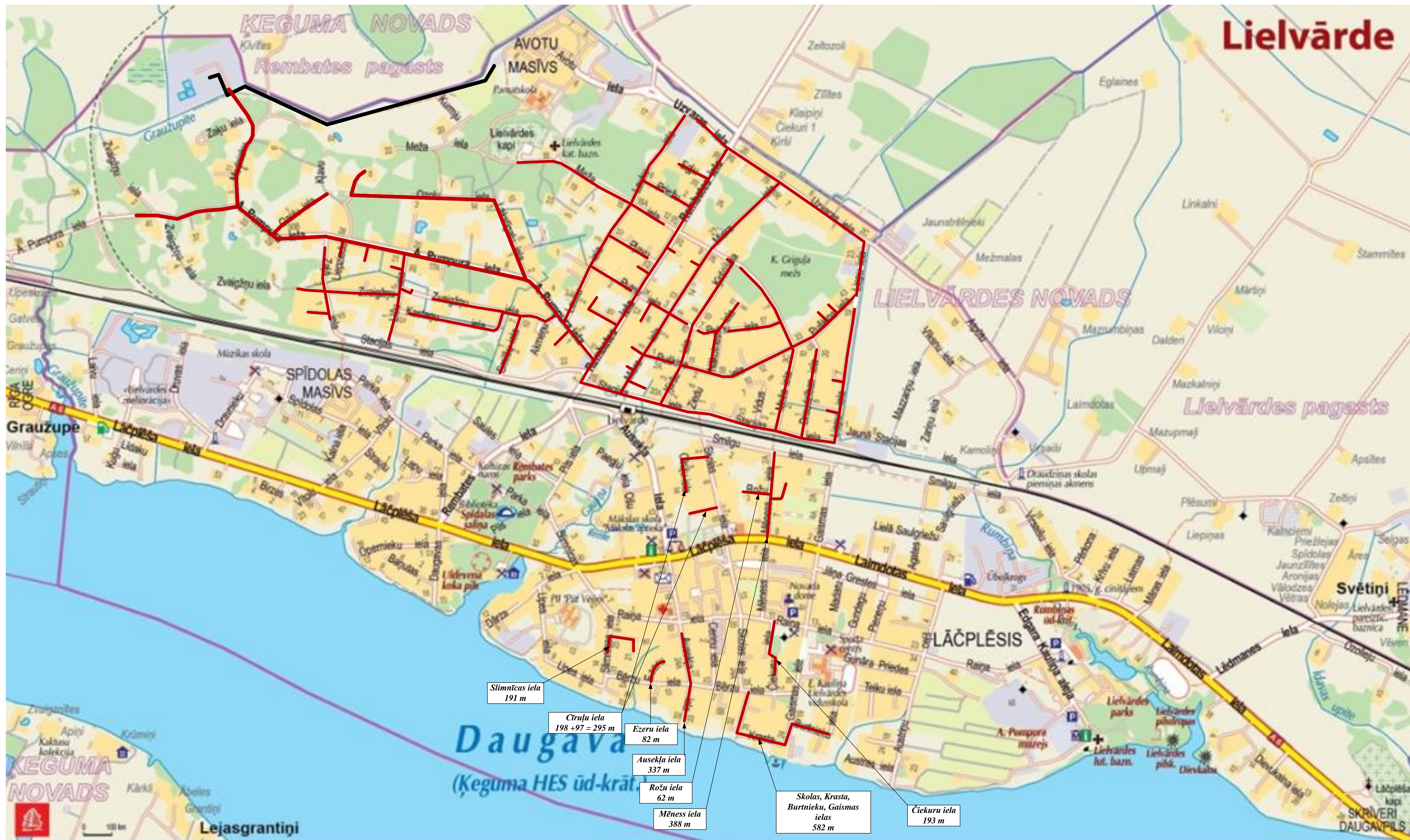
Jaunizbūvējamie kanalizācijas posmi 2130 m
